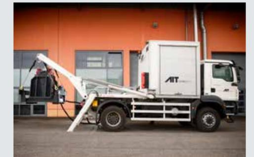
**MoSeS:** Mit dem Mobile Seismic Simulator (15–25 kN/1–80 Hz), einem hydraulischen Erschütterungsgenerator, simulieren wir Schwingungen oder leiten sie in den Boden und in Gebäude ein.
