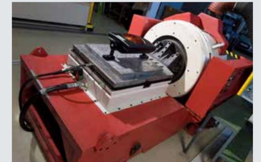
Mit dem elektrodynamischen Shaker führen wir als akkreditierte Prüfstelle für Schock- und Vibrationsprüfungen, optional mit Klimakammer, Tests für elektronische und elektrische Bauteile, Geräte, Maschinen, Anlagen sowie Aufbauten für Fahrzeugteile durch.
