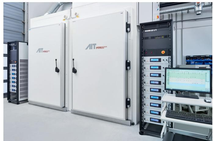
//01 Systemprüfstände mit Klimakammern
