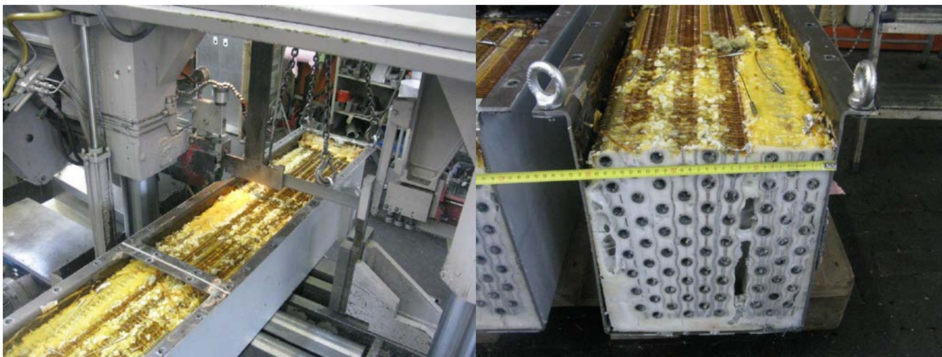
Abbildung 65: Links: Wasserstrahlschneiden des Speichers nach längerem Testbetrieb. Rechts: Oberflächliche Degradation des PCMs, das innere ist jedoch vollständig intakt.
