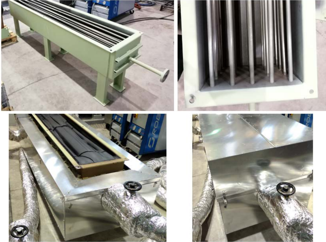
Abbildung 24: Der Polymer-PCM-Speicher wurde für die Einspeicherung von Abwärme aus dem Druckgussprozess für Beladeleistungen bis ca. 50 kW und einer Speicherkapazität von bis zu 100 kWh ausgelegt. Als Wärmeübertrager wurde ein Rohrbündel aus Stahl verwendet mit Sammlern, um eine gleichmäßige parallele Durchströmung zu gewährleisten. Als PCM wurde ein eigenes im Projekt entwickeltes wärmeleitfähiges HDPE-Compound entwickelt und vom Projektpartner gebildet hergestellt. Die thermische Isolierung erfolgte vor Ort. Die Sensorik wurde entsprechend ins Leitsystem integriert und erlaubt eine genaue Zustandsüberwachung. Durch die speziell entwickelten Regelungsalgorithmen kann eine Be- und Entladung mit vorgebbarem Temperatur- und Leistungsprofil erreicht werden.
