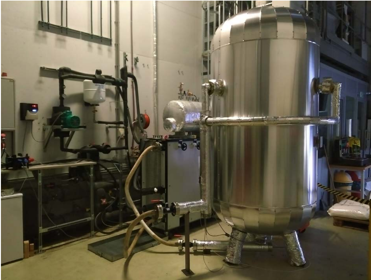
Abbildung 55: Speicherteststand im eigens entwickelten Speicherlabor am AIT. Be- und Entladeleistungen bis 100 kW sowie Temperaturen bis 350 °C können erreicht werden. Die Steuerung und Datenerfassung erfolgt mittels zentralem Leitsystem.
