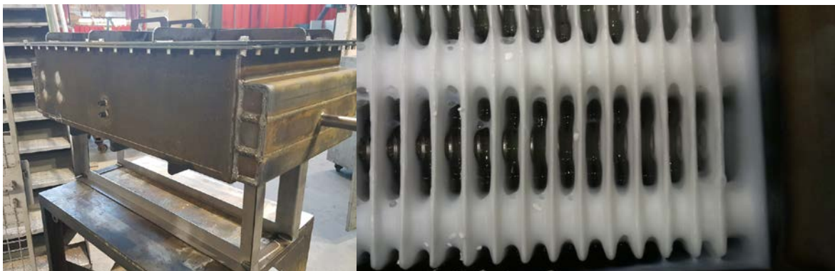
Abbildung 49: Der zweite Speicher, der mit Lamellenrohrbündelwärmeübertrager gebaut wurde. Bei diesem Speicher wurde eine erhöhte Festigkeitskonstruktion sowie Abdichtung entwickelt, die eine Überlagerung des
