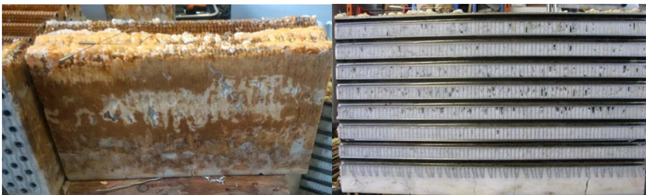
Abbildung 66: Links: Entlang der Außenwand des Speichers konnte offenbar luftsauerstoff eindringen und führte zur Degradation des Polymer-PCMs. Rechts: Das HDPE im inneren des Speichers ist intakt, ebenso ist die Geometrie des Wärmeübertragers unverändert, was entscheidend für die Speicherleistung ist.
