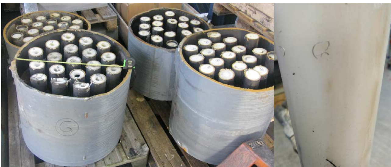
Abbildung 67: Links: Das PCM in den Rohren ins vollständig intakt. Rechts: Nahaufnahme des HDPE aus dem Rohr. Keine Verfärbung aufgrund von Degradation ist erkennbar.
