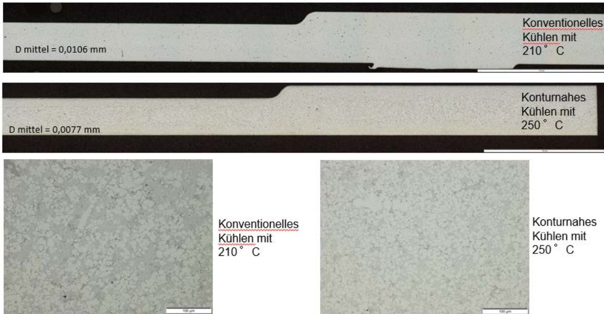
Abbildung 22: Vergleich der Mikrostruktur für konventionelles Kühlen mit 210 °C Thermoöleintrittstemperatur und 250 °C mit konturnahem Kühlen. Durch die verbesserte Kühlleistung wird ein schnelleres Abkühlen möglich, was sich auch in einer verbesserten Mikrostruktur (kleinere Kristalliten, weniger Korngrenzen) auswirkt.
